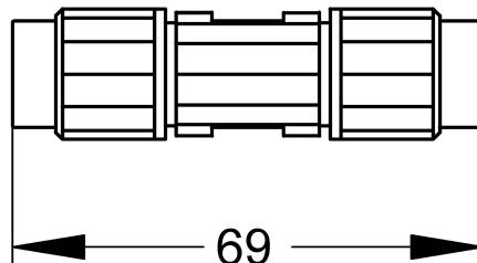
**KWC-Nr.****2000100857**Kupplung für Systemkabel – A3000 open, Verpackungseinheit 5
