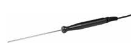
Hand-Temperaturfühler, Figur 138 00 003 Zum Messen von Wassertemperaturen, insbesondere von Trink- wassertemperaturen im Bereich des Auslaufes der Entnahme- stelle vor Ort. Schnell reagierender Fühler zur Feststellung von Temperaturschwankungen; Temperaturmessbereich 0 - 150 °C; 150 mm lange Messspitze aus Edelstahl
